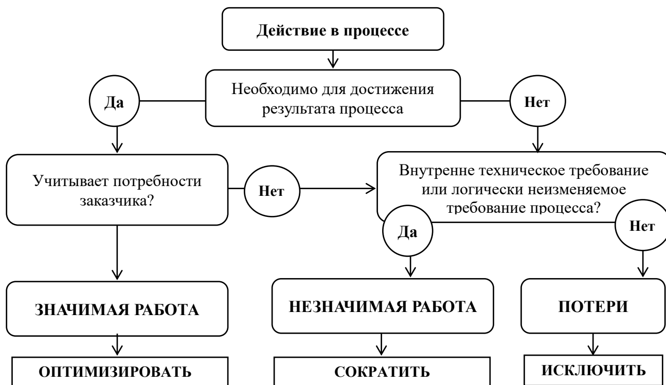
Рис. 12. Алгоритм анализа действий в процессе
